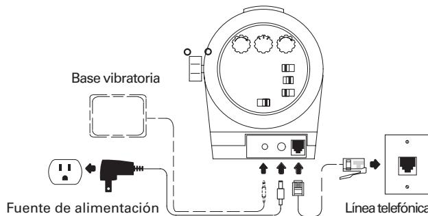
**Importante:** Para conectar el reloj despertador a una conexión telefónica para su uso como amplificador de señal, es posible que se requiera un adaptador apropiado.
