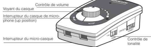
3. Ajustement de l'interrupteur de compatibilité: Ils y a sept (7) positions à l'interrupteur. Les positions 1 à 6 sont pour des ajustements de compatibilité. La position 7 est une position de contournement et n'est pas pour un usage régulier. Elle n'offre aucune amplification et ne devrait être utilisé qu'en cas d'urgence, comme lors d'une panne totale d'électricité.
