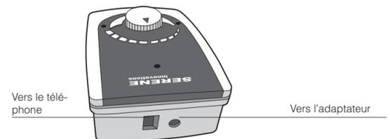
7. L'adaptateur fourni le courant pour un usage régulier. Lors des pannes de courant, l'installation d'une pile prend le relais. La pile devrait être changée au deux (2) ans ou dès que le voyant Marche/Arrêt omet de s'allumer lors d'une panne
